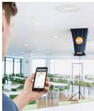
Connexion à l'application via Bluetooth pour l'affichage des données de mesure sur les appareils mobiles et la finalisation des protocoles de mesure sur site.
