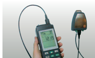
Contrôle des convertisseurs de mesure avec interface 4...20 mA
