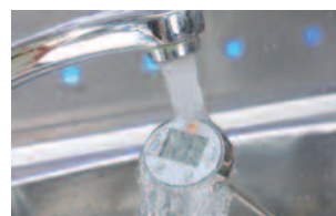
Nettoyage du mini-thermomètre par simple rinçage sous l'eau.
